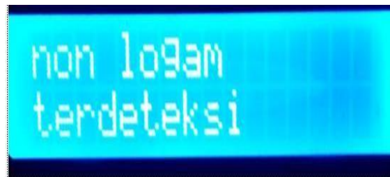
Gambar 16. Tampilan LCD saat nonlogam terdeteksi
