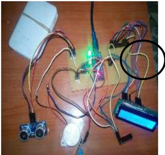
Gambar 6. Titik point pengukuran tegangan Vout sensor HC-Sr04
