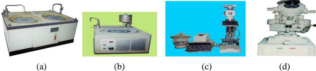
**Gambar 1. Peralatan Penunjang Metalurgi Permukaan yaitu : a. Mesin penggerindaan b. Mesin polishing c. Mikroskop dan specimen d. Microhardness test**
