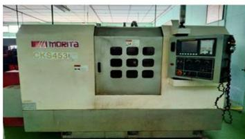
Gambar 1. Mesin Bubut CNC
