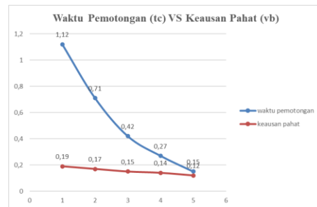
Gambar 6. Pengaruh Waktu Pemotongan Dan Keausan Pahat.
