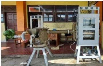
Gambar 1. Alat Pengering Biji Kopi Menggunakan Udara Panas Yang Digunakan
