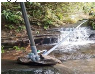
Gambar 1. Operasi Pompa Hidram
