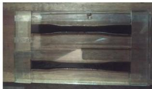
Gambar 3. Cetakan Specimen
