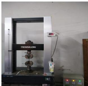
Gambar 6. Mesin Uji Tarik
