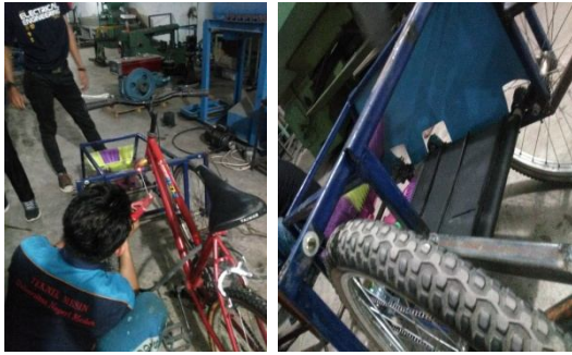
Gambar 11. Proses menyatukan sepeda dan rangka depan penyapu
