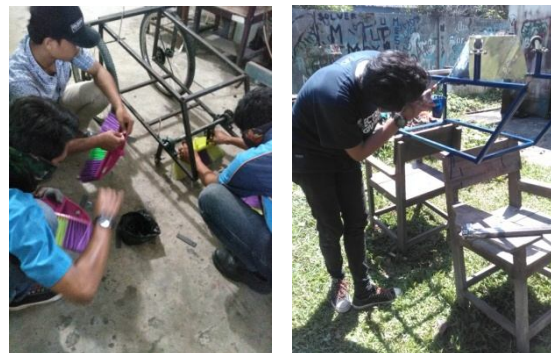
Gambar 10. proses pembuatan dan pengecatan rangka depan penyapu
