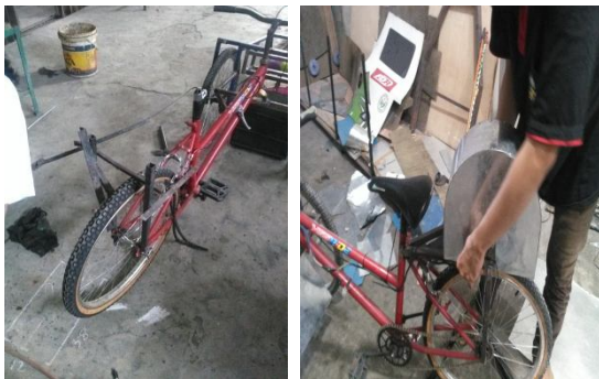
Gambar 13. Proses pembuatan dudukan dan penutup motor BLDC
