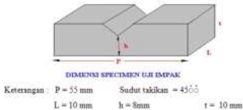
Gambar 11. Spesimen Uji Impak
