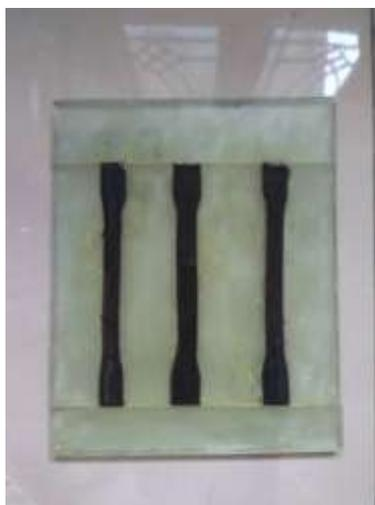
Gambar 3. Spesimen uji tarik
