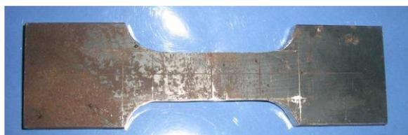
**Gambar 12. Spesimen Uji Tarik Sebelum Diuji**
