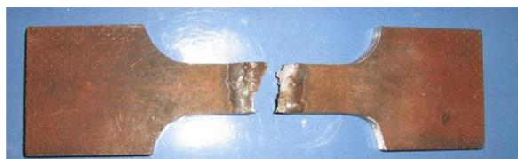
**Gambar 13. Spesimen Uji Tarik Setelah Diuji**
