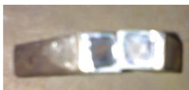
**Gambar 16. Spesimen Pengelasan Dengan Kuat Arus 120 Ampere Yang Telah Diuji Impact**
