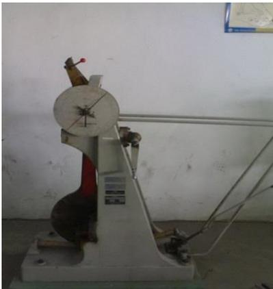
Gambar 9. Mesin Uji Impak
